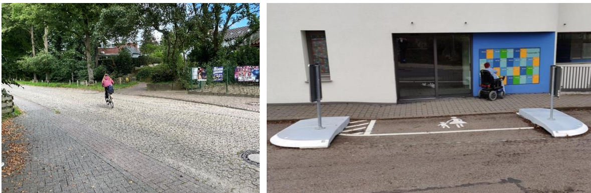
Abbildung 16: Querungssituation Übern Berg (links) und Beispiel einer temporären Gehwegnase (rechts)
