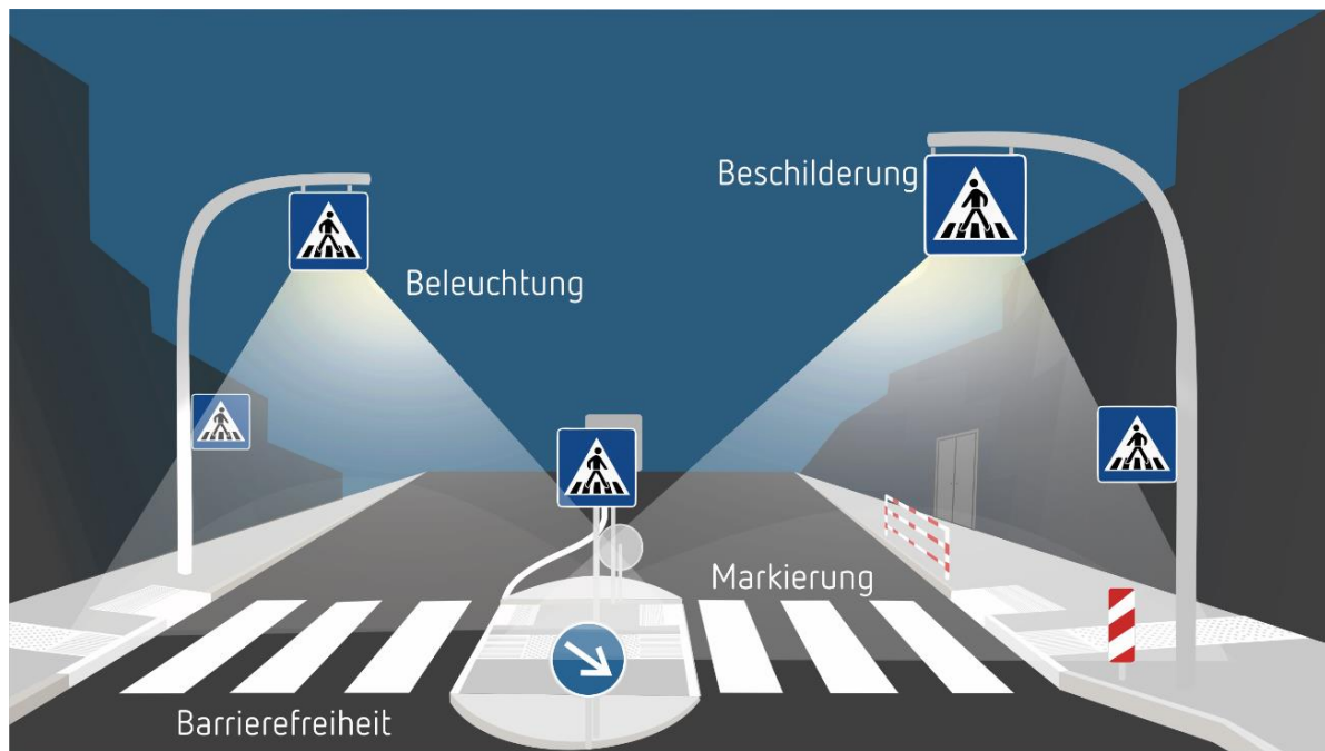
Abbildung 13: Ausstattungselemente eines FGÜ
