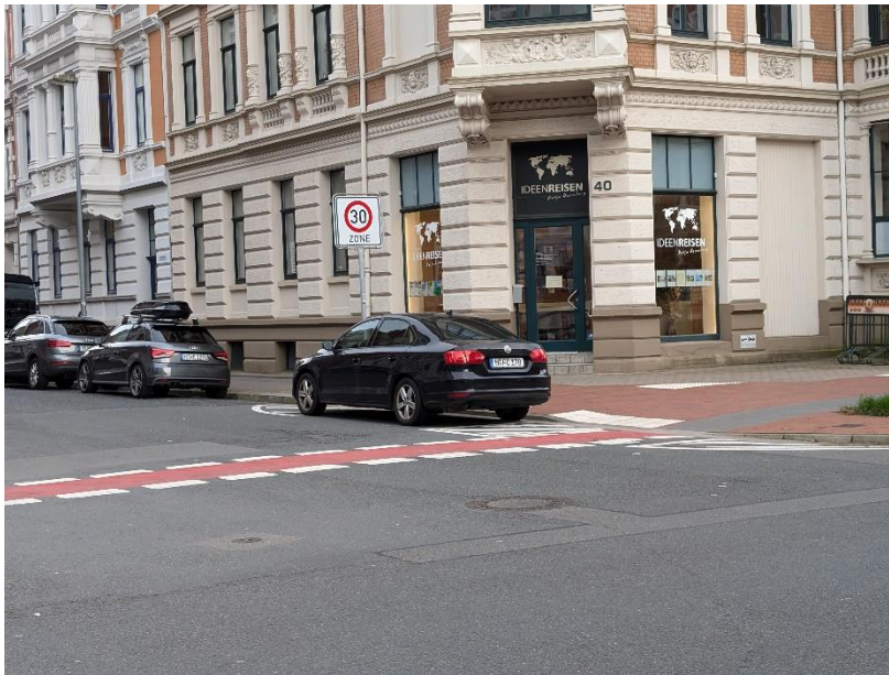
Zickzack-Markierung zur Verdeutlichung des Halteverbots
